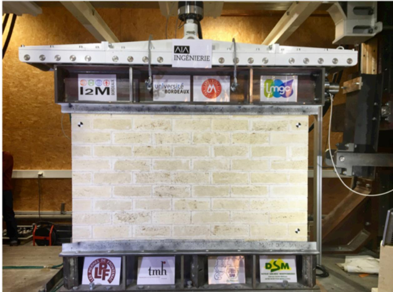
FIGURE 4.2 – Photographie du mur monté et appareillé
